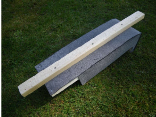
Foto 12: Auf der Rückseite ein Stück Dachlatte oder ein Brett zum Aufhängen aufschrauben (Achtung: Schraubenspitzen dürfen nicht in den Kasten ragen!)
